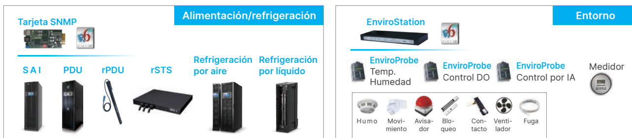
FIGURA 1. Aplicación de supervisión de Delta InfraSuite Device Master
